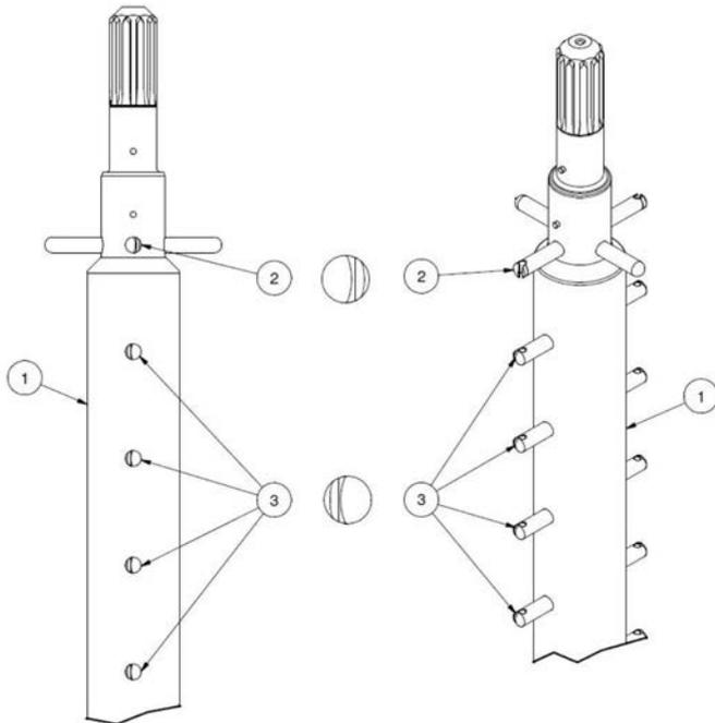
**Figure 8-6. Blade Pin Orientation**
