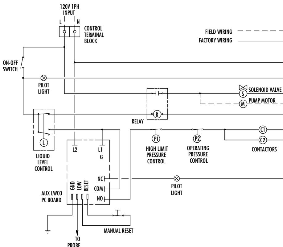
**Wiring Diagram Control Circuit**
