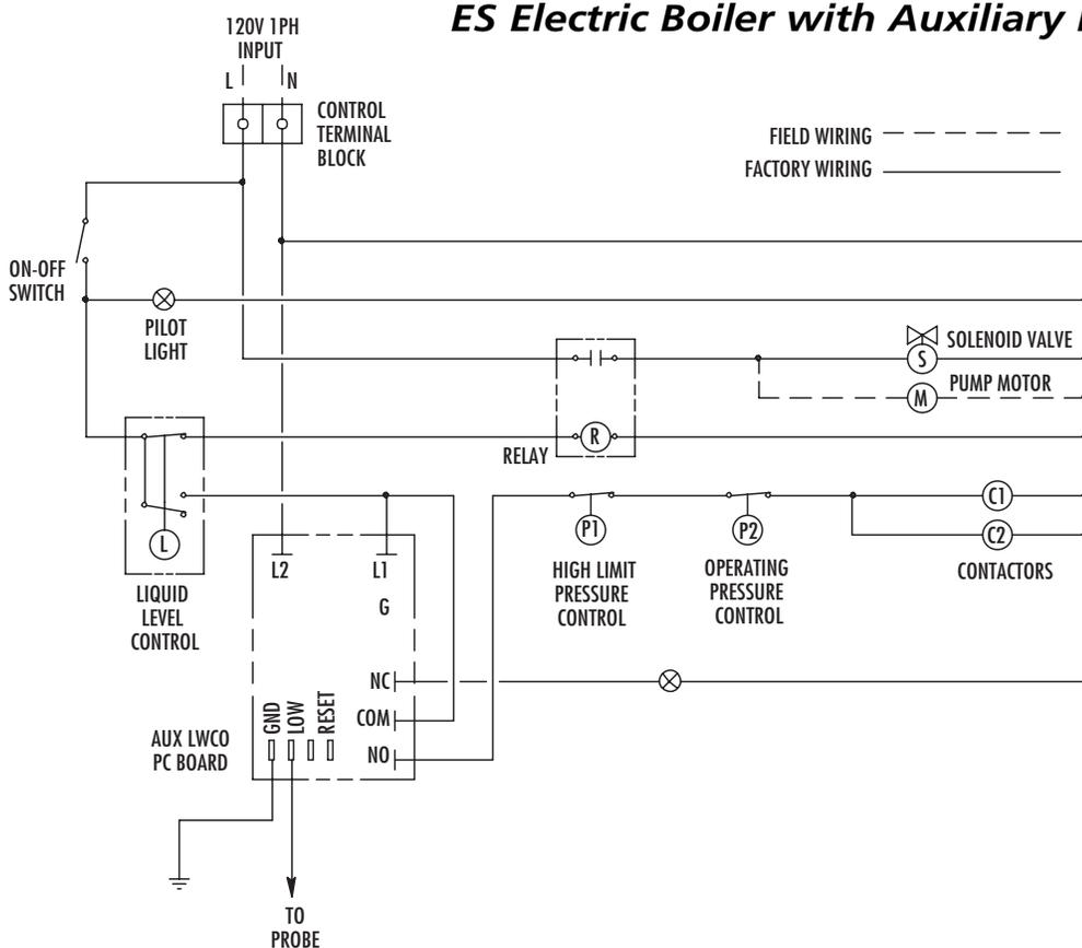
**Wiring Diagram Control Circuit**
